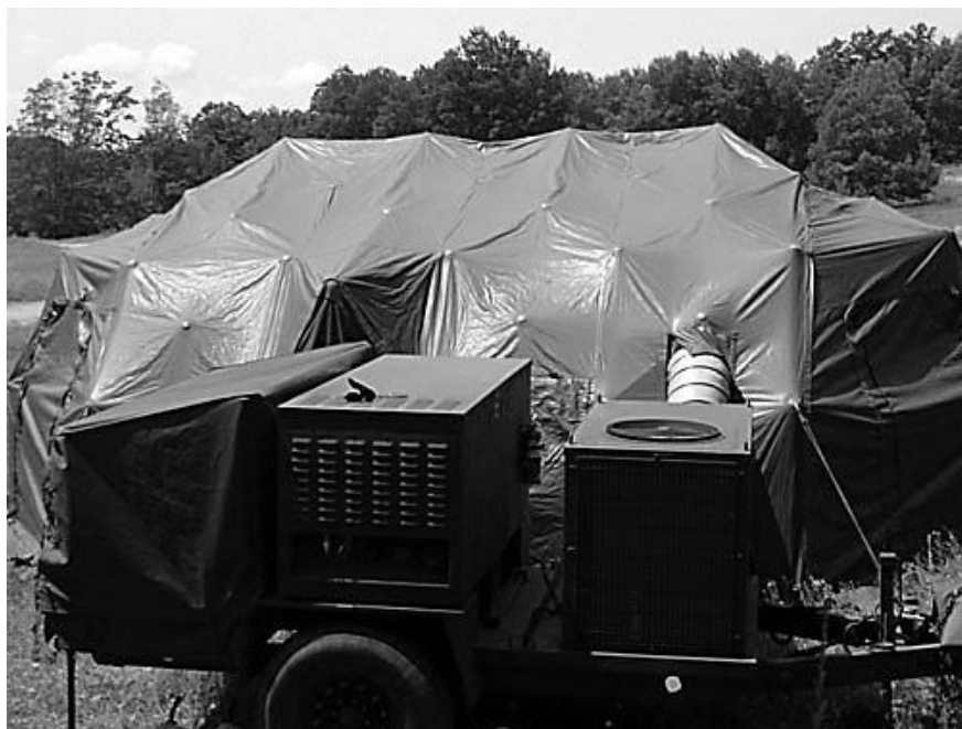
شکل ۸-۸: پناهگاه غشایی NBC نوع داخلی و اتصال فیلتر به آن
