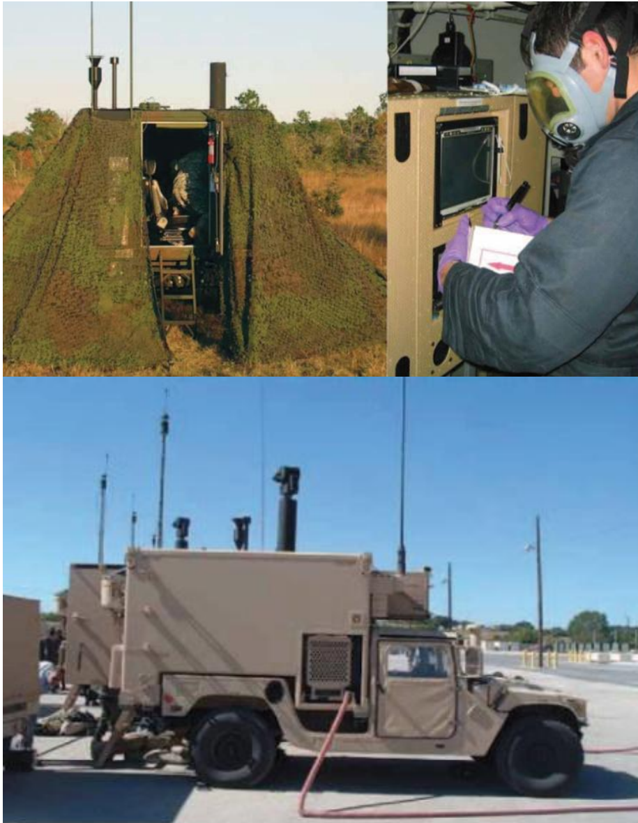
شکل ۳-۲۳: نمونه ای از دستگاه JBPDS و کاربری آن
