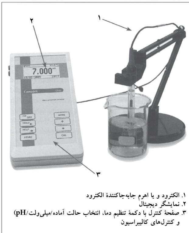
pH متر برای تعیین غلظت یون هیدروژن  $[H^+]$  در یک محلول کاربرد دارد. اگر این دستگاه با احتیاط استفاده و کالیبر شود، قدرت اسیدی محلول را اندازه‌گیری می‌کند. pH مترها گاهی دستگاه تجزیه pH، نمایشگر pH و یا سیستم الکتروشیمی<sup>۱</sup> نیز نامیده می‌شوند.
